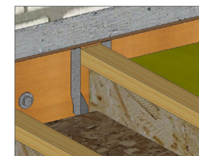
Solives fixées aux muralières par étriers IUSE
