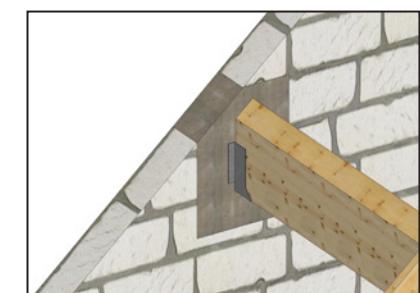
Panne posée d'aplomb avec délardement de la face supérieure pour supporter un chevron
