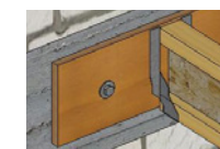
La muralière est chevillée au chaînage béton
