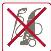
Ne procédez jamais à un lavage « haute pression », ni sur les bardages peints car la pression userait prématurément la finition, ni sur les bardages naturellement durable ou préservé. Cela risquerait d'abîmer le veinage du bois et relever les fibres de bois.
