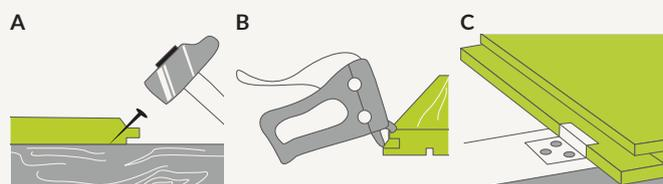
Les poses de la 1<sup>ère</sup> lame en partie basse et de la dernière lame en partie haute se font avec des pointes à têtes d'homme d'une longueur d'au moins l'épaisseur de la lame + 10 mm.
