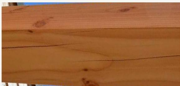
Le bois est sujet à des variations dimensionnelles en fonction du taux d'humidité et de la température. Lorsqu'il sèche, il se rétracte de façon irrégulière, entraînant l'apparition de fentes.
