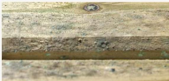
Les bois sont sujets aux moisissures de discoloration, provoquées par des champignons microscopiques. Cette discoloration superficielle, renforcée par la chaleur, l'humidité et le manque d'aération, se caractérise par des tâches allant du bleu clair au bleu noir. Un léger brossage permet de les éliminer.
