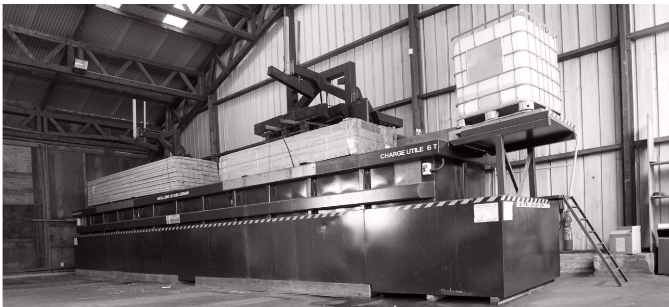
Bac de préservation Classe 2 - Site de Bouguenais (44)
