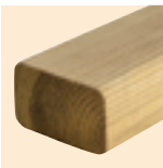
Lambourde Pin Rouge du Nord 45 x 70 mm Préservation Classe 4 en autoclave vert ou marron Marquage CE selon NF EN 14081-1 Classe mécanique C24
